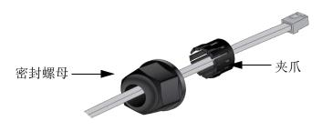
5. 打开密封插件并将其装到太网线上。 带凹槽的末端需朝向夹爪,夹爪抓手需指向密封螺母。
