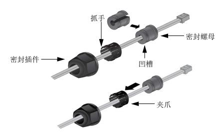
7. 将以太网电缆上的 RJ-45 连接器连接到密封组件内的以太网 LAN 端口,拧紧接入点上的密封螺母。
