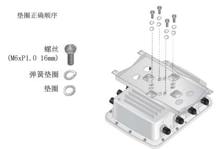
6. 使用随附的螺丝将接入点连接到墙上。
